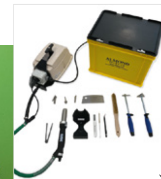
Een lasapparaat van Almond Techniek om kunststof te bewerken.
